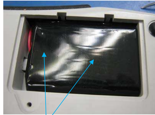
Pilin üzerinde kablo bulunmadıęından emin olun
