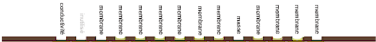
VUE LONGITUDINALE DU CANAL DE CAPTEUR DU MODULE APRÈS IMPRESSION DE LA MEMBRANE
